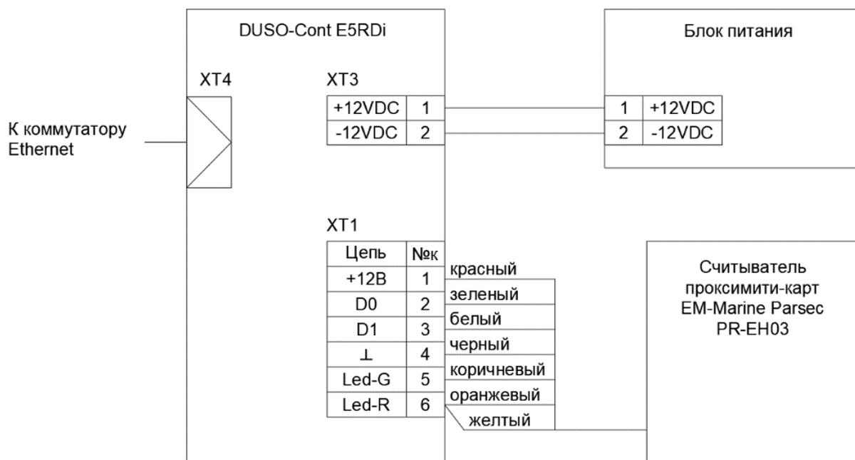
Примечание: 1. В схеме подключения в качестве примера показан считыватель проксимити-карт PARSEC PR-EH03. Цвета проводов, подключаемых к контактам контроллера «DUSO-Cont E5RDi», взяты из документации на данный считыватель. Для остальных считывателей подключение осуществляется аналогично.
