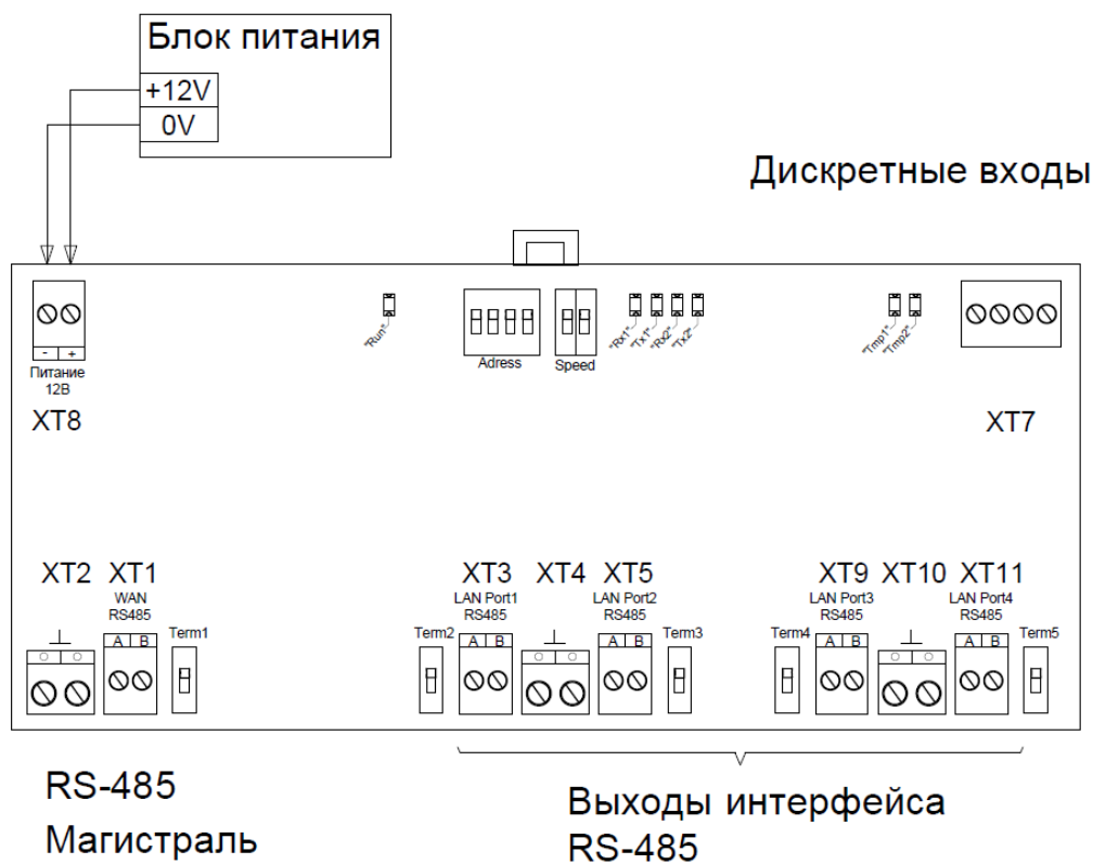
Рис. 2. Подключение источников питания контроллера «DUSO-Cont R4».
